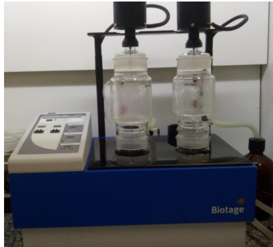
Figura 23. Concentración de bitumen
