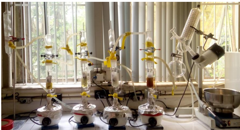
Figura 21. Realización del montaje para la extracción del bitumen
