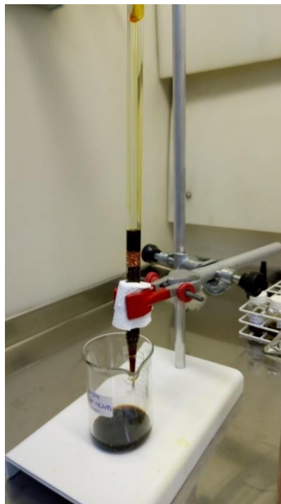
Figura 24. Columna de cobre para la eliminación de azufre
