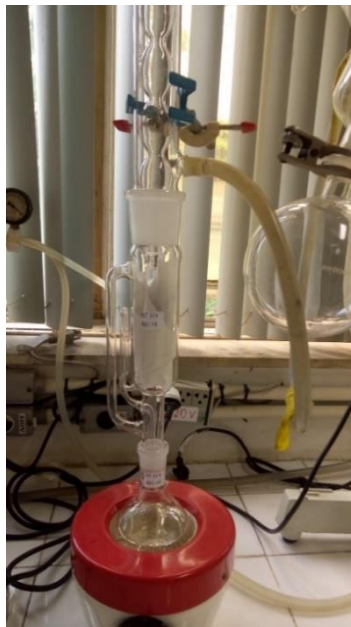
Figura 20. Montaje de la muestra en el extractor soxhlet
