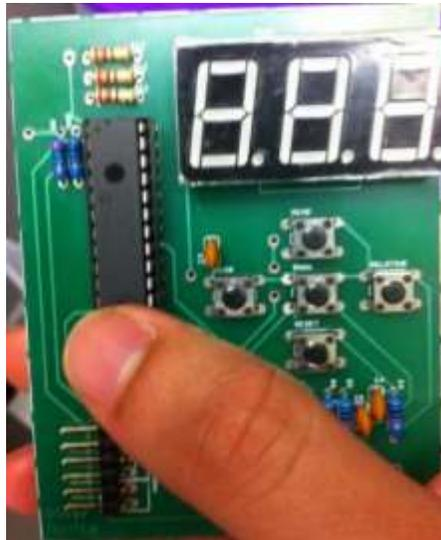
Figura 18: Circuito impreso del sistema de control del equipo portátil de fluorescencia.
