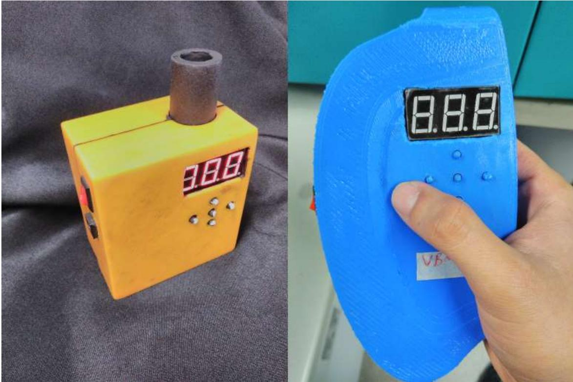
**Figura 19:** Dos diseños impresos del fluorímetro portátil.
