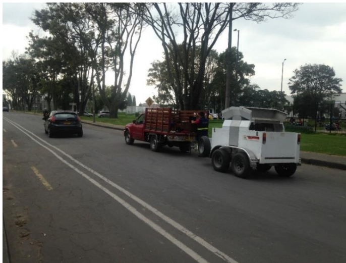
Figura 3-9: Deflectometria con equipo FWD marca Jils, tramo TRM.
