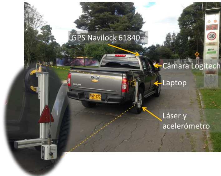
Figura 3-6: Perfilómetro laser PL Unibox - Logiroad IRI, Universidad Nacional de Colombia.
