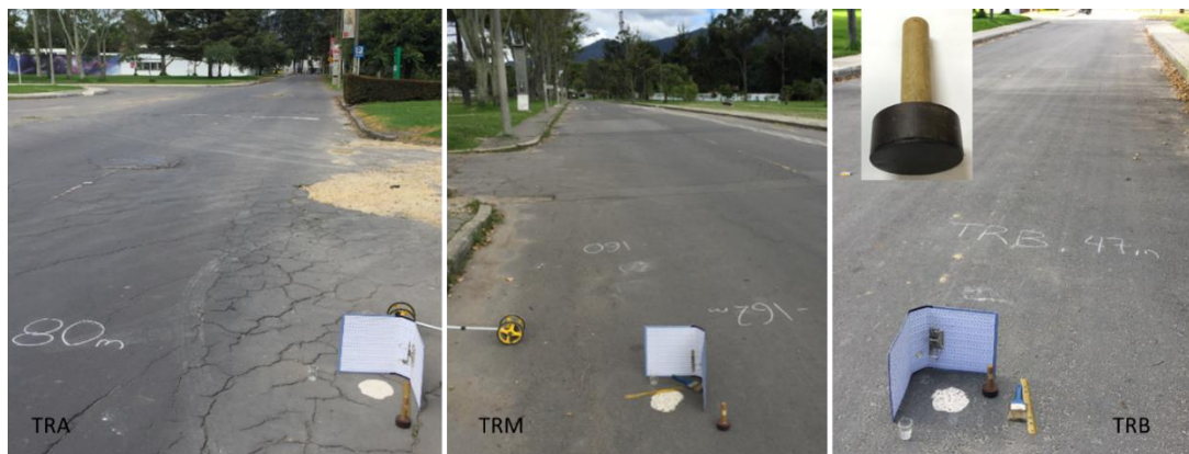
Figura 3-4: Medición de macrotextura superficial.
