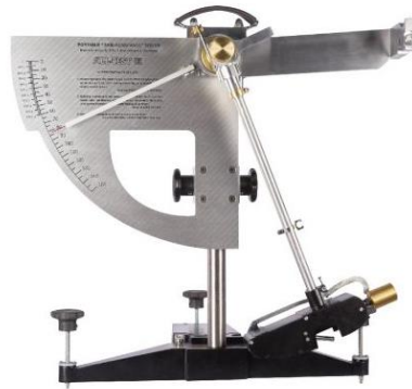
Figura 2-1: Equipo Péndulo Británico 5 , para mediciones de microtextura.
