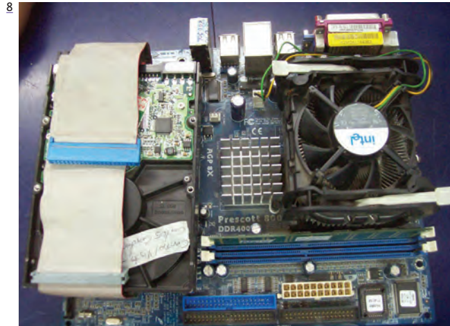
Imágenes 8, 9 y 10. Piezas ensambladas al interior de una rocola: motherboard, procesador, monedero electrónico
