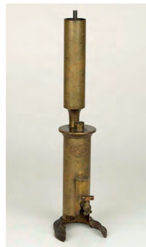
Imagen 8. [Hipsómetro utilizado por Francisco José de Caldas para medir las alturas sobre el nivel del mar. Casa Museo Francisco José de Caldas]
