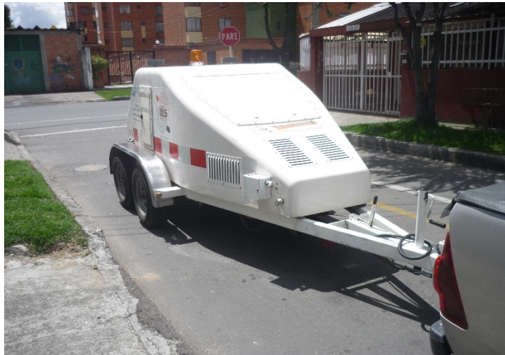
Figura 2-1. Equipo FWD marca JILS.
