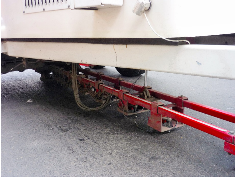
Figura 2-2. Geófonos del equipo FWD.
