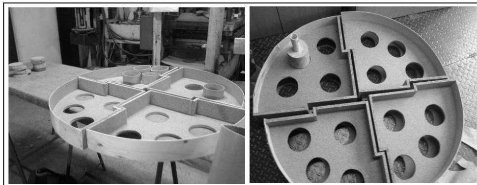
**Figura 7.** Formaleta en madera para la fabricación de soporte circular
