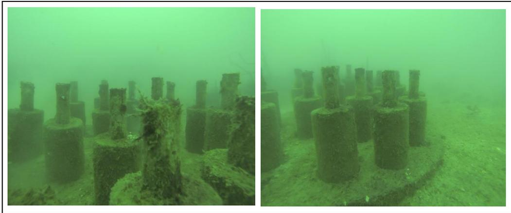
**Figura 37** Colonización de los módulos de prueba, mes 3. Sitio 2. Se observa que el modulo conserva su estabilidad Fuente propia.
