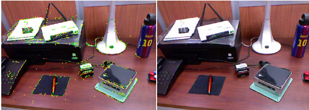
Figura 5.9 Odometría visual ( izq. ) y detección de bucles cerrados ( der. ) llevados a cabo por el sistema RTAB-Map.
