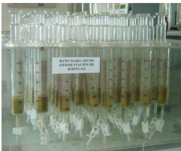
Figura 6 Baño maría a 39°C utilizado para las fermentaciones cecales in vitro en jeringas
