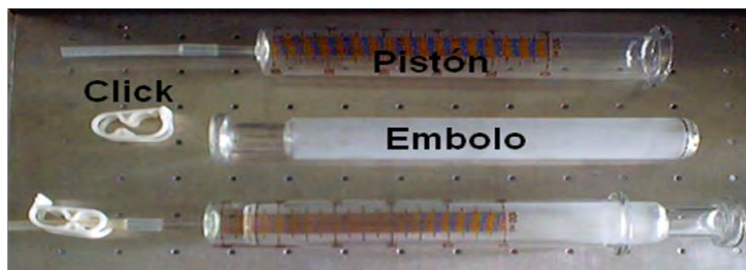
Figura 5 Partes de jeringas utilizadas en la prueba de fermentación in vitro
