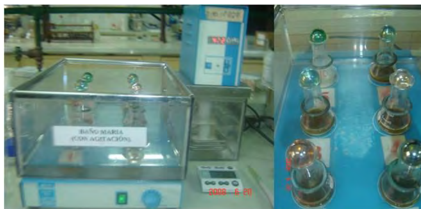
Figura 4 Baño maría utilizado para la cinética de hidrólisis in vitro de las proteínas del follaje de leguminosas tropicales y controles (Bore y torta de soya).
