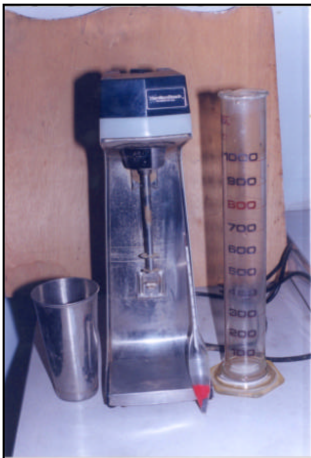
FIGURA 7.1. Implementos utilizados para la determinación de la textura del suelo por el método del hidrómetro.
