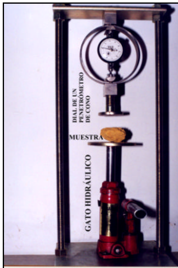
FIGURA 10.4. Equipo para determinar módulo de ruptura, adaptado con el dial de un penetrómetro de cono.
