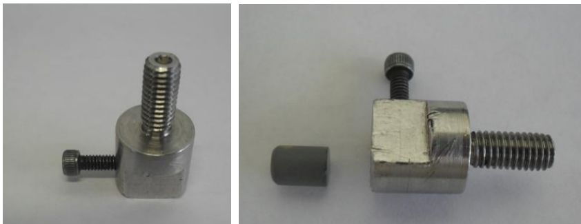
Figura 4-7 Portapin y muestra de Ti6Al4V modificado.
