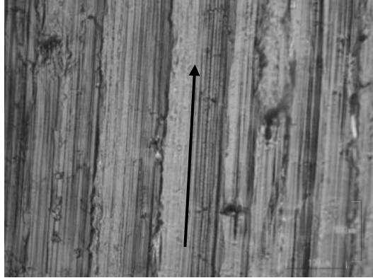
Figura 5.28 Micrografía MO de UHMWPE que presenta deformación plástica tipo arado. La flecha indica la dirección de deslizamiento.
