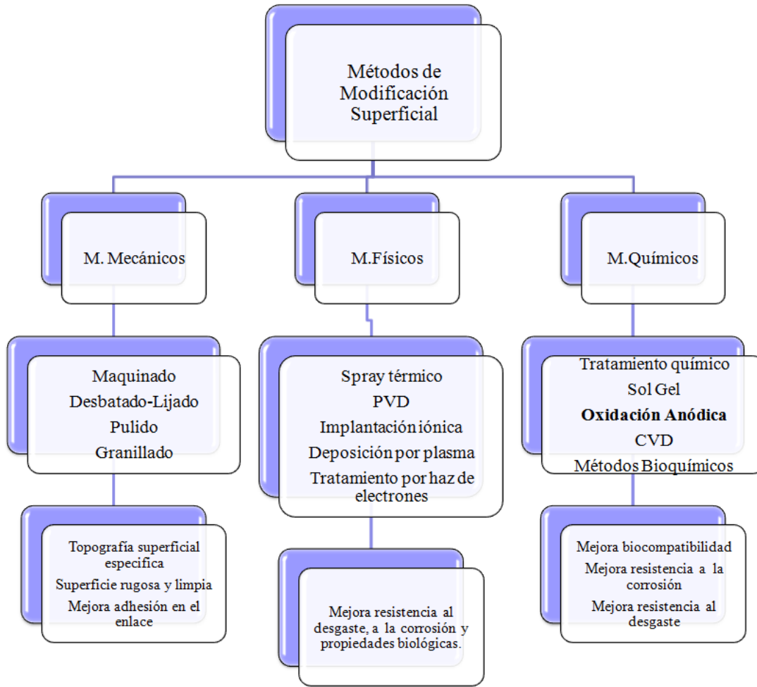
Figura 3.1 Diagrama Métodos de modificación superficial en aleaciones de titanio. [Liu, et al[15]] Adaptado por autor.
