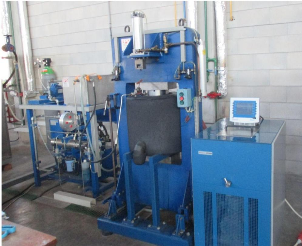
Figura 2-1. Equipo piloto de altas presiones hidrostáticas.
