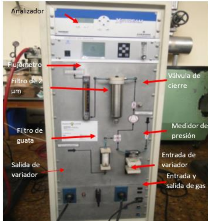
Ilustración 13: Analizador de gases
