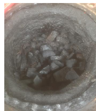
Figura 3. Carga de carbón natural en modulo inferior.
