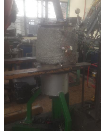
Figura 5. Montaje de módulos de gasificador.
