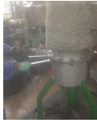
Figura 7. Ajuste de tuercas a cuerpo de gasificador.
