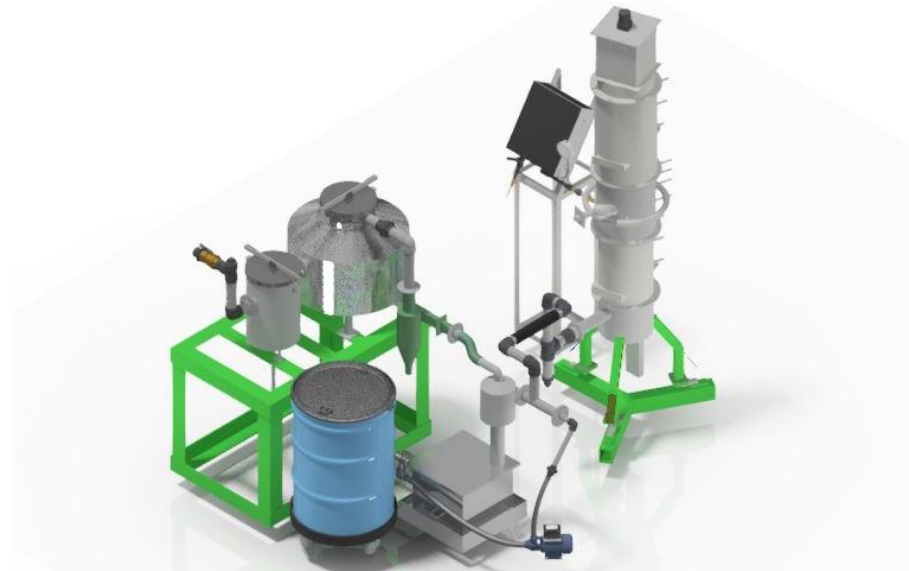
Ilustración 5: Planta de Gasificación
