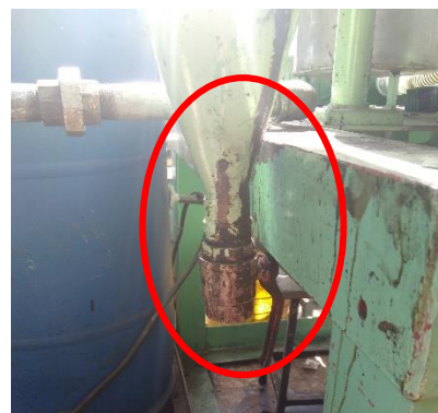
Figura 12. Válvula cerrada ciclón
