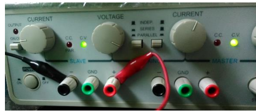
Figura 20 Conexión entrada positiva y negativa
