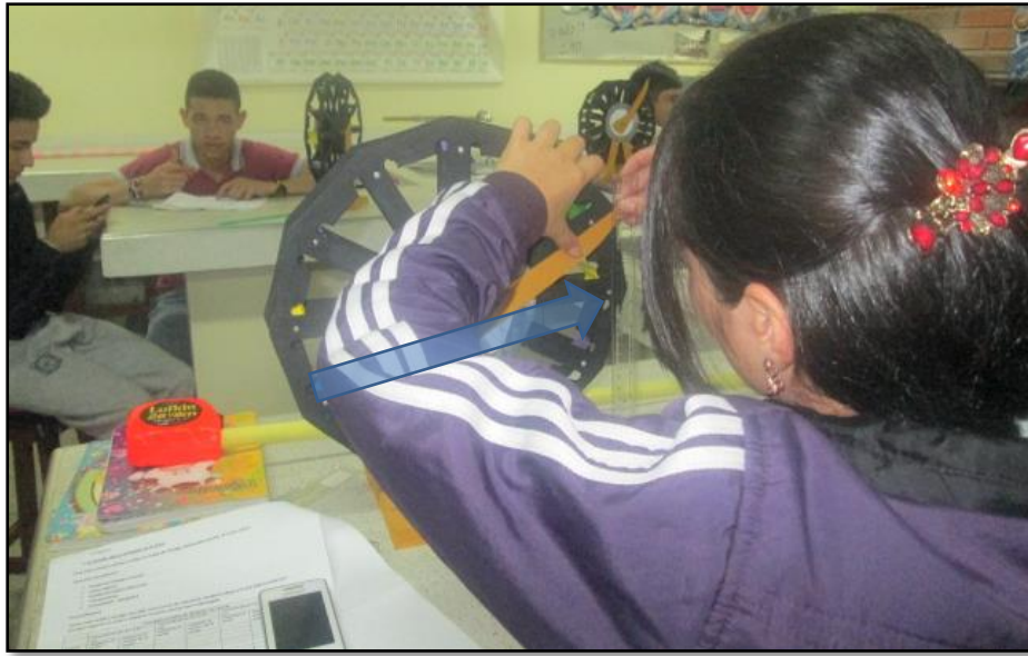
Figura 3-1 Toma de datos sobre la altura de una silla de la rueda mientras varía el ángulo
