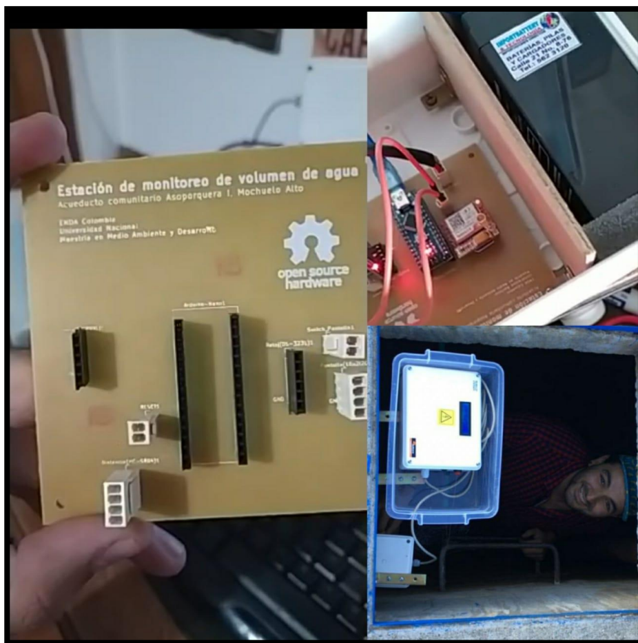
Figura 3-6: Segundo prototipo de estación de monitoreo comunitario de volumen de agua
