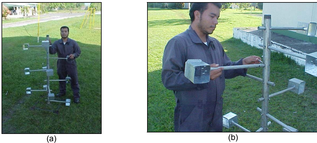
Figura 6. Trampa propuesta por el CCCP (2004). (a) Vista lateral (B) Soporte de la bolsa anclado a la torre
