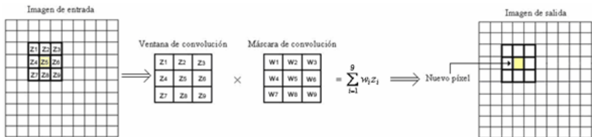
Figura 13: Operación de convolución de máscara con una imagen
