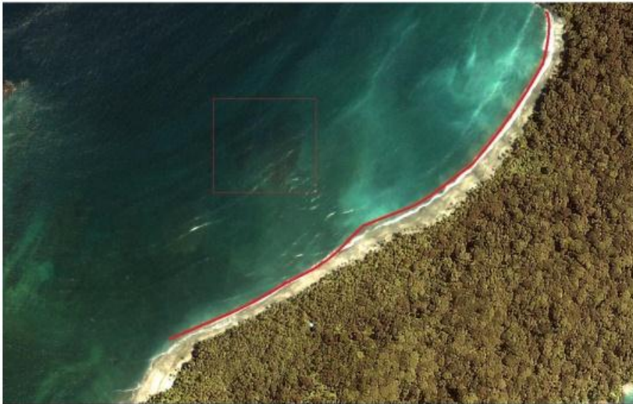
Figura 3-14 Imagen Ikonos de la zona de estudio mostrando las dos formas en planta de playa Palmeras, teniendo en cuenta el tómbolo natural generado por el bajo rocoso señalado en el rectángulo.
