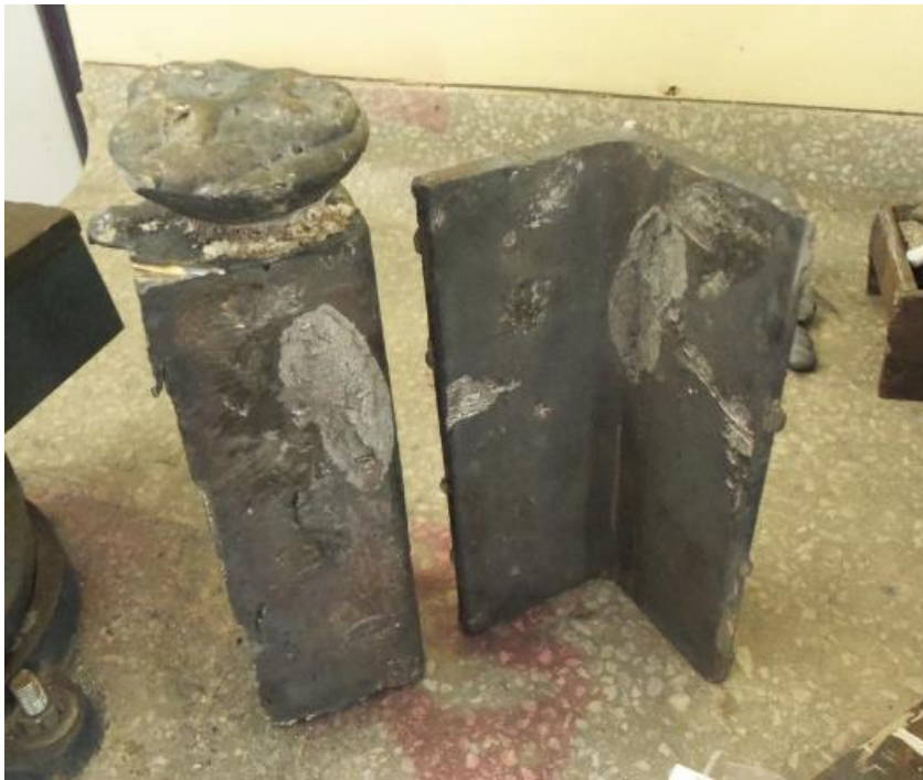
Fotografía 32: Fotografía de la fundición y adhesión del molde de acero con el acero obtenido.
