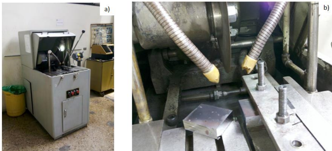
Fotografía 37: a) Fotografía de la máquina de corte refrigerada, con la cual se realizaron los cortes del material para la obtención de las probetas a analizar b) ampliación de la sección de la maquina donde está ubicado el disco de corte y muestra un bloque de acero bainítico ya cortado.
