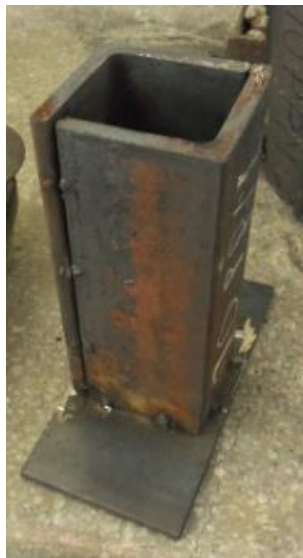
Fotografía 30: Fotografía de uno de los moldes hechos en acero estructural para las fundiciones realizadas.
