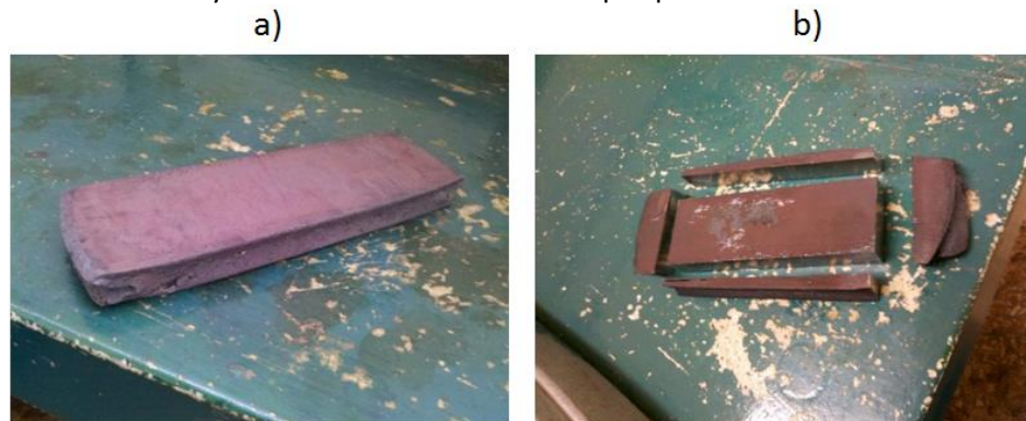
Fotografía 36: Fotografías del material obtenido a) después del proceso de laminación en caliente b) después del proceso de corte por el cual fueron removidos los bordes.
