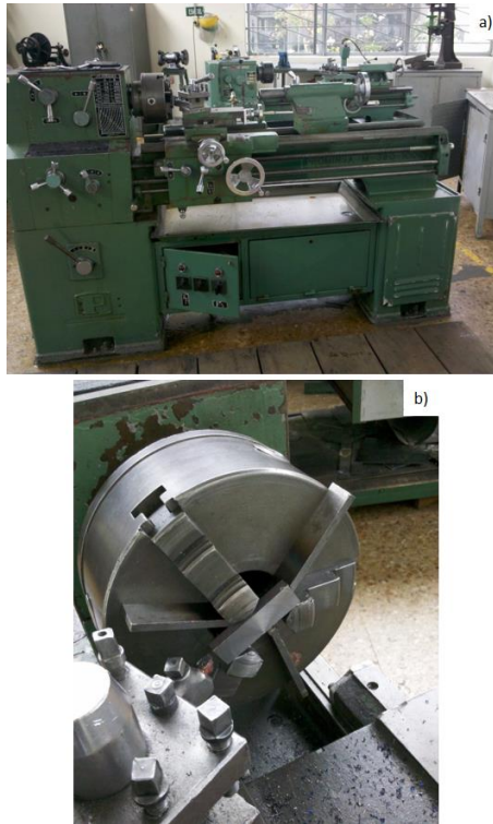
Fotografía 38: Fotografías del torno y la montura usados en la Universidad Nacional de Colombia para hacer el proceso de refrentado sobre las probetas de acero bainítico.
