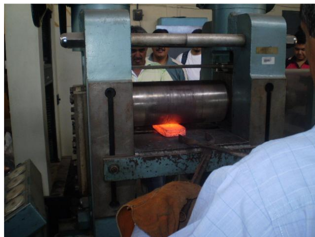
Fotografía 35: Fotografía del proceso de laminación en caliente del material [46].
