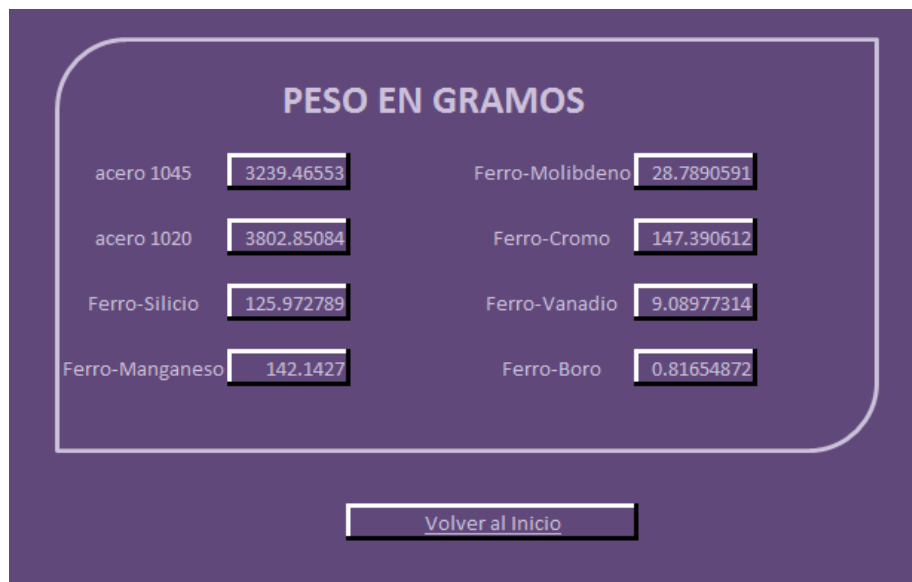
Figura 44: Hoja de resultados mostrados por la tabla de Excel para proceder a pesar los ferroaleantes y así realizar las fundiciones que se deseen.
