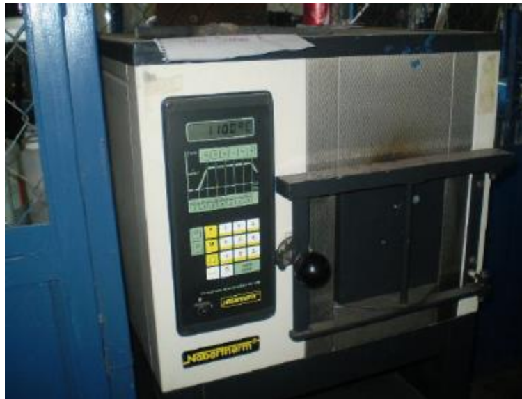
Fotografía 34: Fotografía del horno tipo mufla con el cual se calentaron los lingotes antes de su proceso de laminación. [46].
