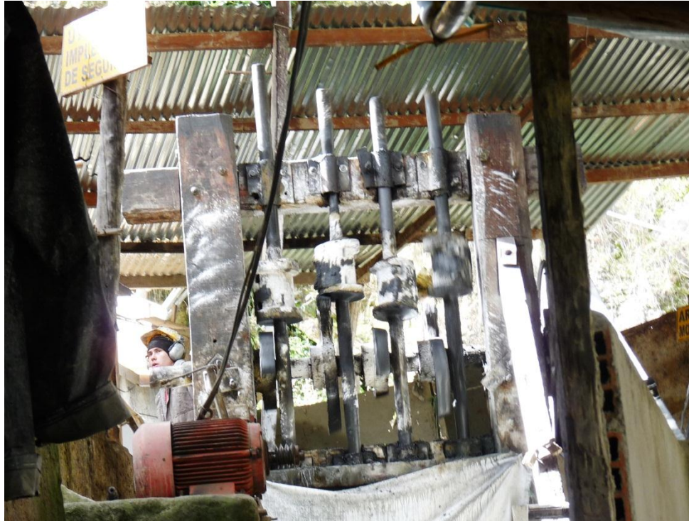
Imagen 1: Molino californiano, Empresa de minería a pequeña escala La Elsy, 12 de Octubre del 2011.
