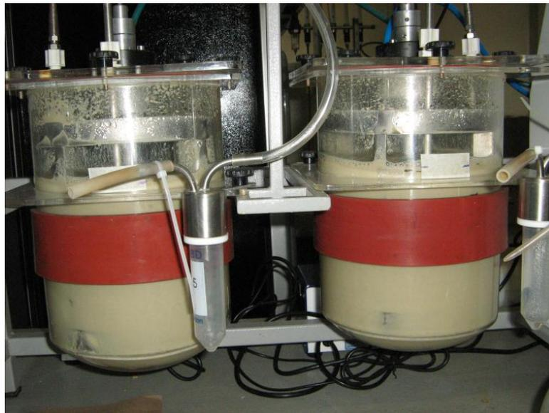
**Figura A-3:** Dispersión del aire y suspensión de los sólidos en los ensayos de biooxidación realizados en el reactor de 5L variando la velocidad de agitación
