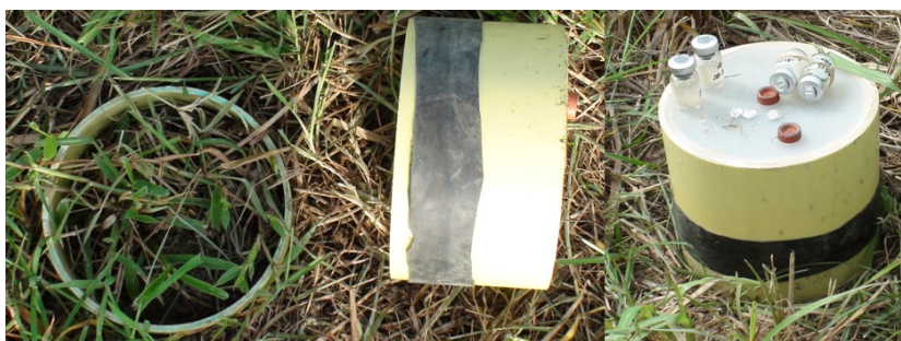
Foto 1: Instalación de anillos y cámara
