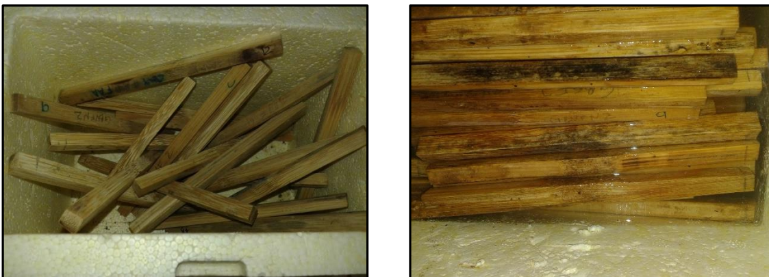
Figura 3-49. Ensayo de absorción de agua en probetas de Guadua a.
