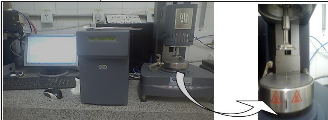
Figura 2-8. Fotografía del reómetro de cono y placa AR 2000 mostrando el levantamiento del cono al culminar el ensayo.
