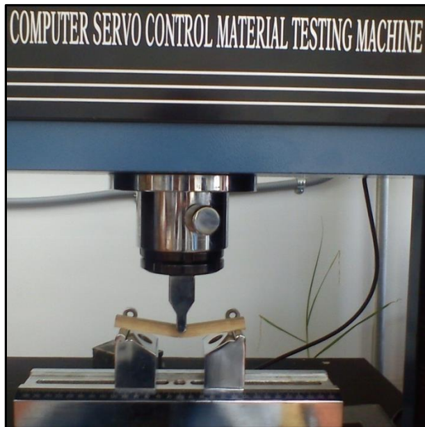
Figura 3-19: Ensayo de flexión longitudinal
