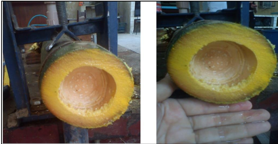
Figura 3-22: Proceso de desplazamiento de sustancias usando agua en un sistema adaptado del método Boucherie.
