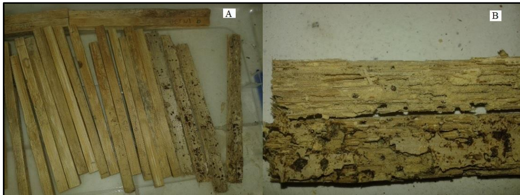
Figura 3-50. Fotografías de las probetas sometidas a contacto con Dinoderus minutus
