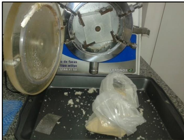
Figura 3-21. Proceso de molienda de las probetas
