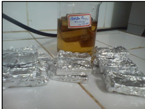
Figura 3-17. Preparación de las probetas para el secado posterior a la infiltración
