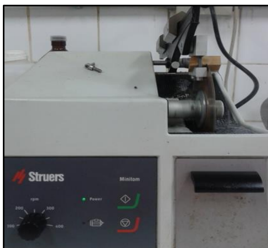
Figura 3-20. Corte de las probetas usando equipo de corte de precisión
