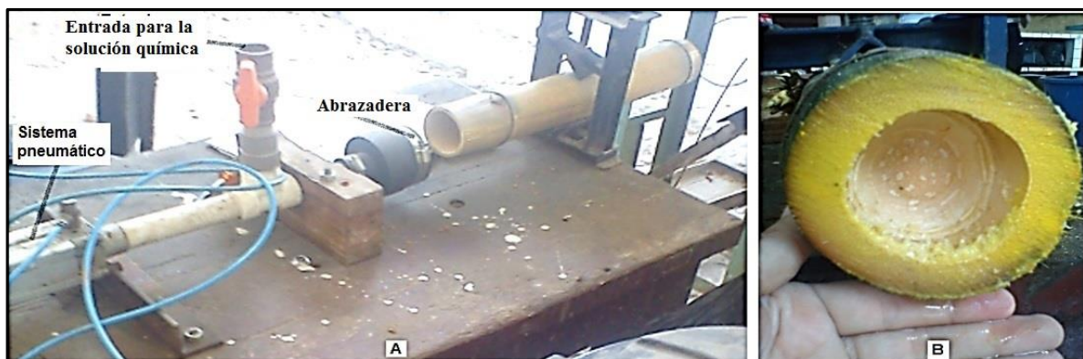
Figura 3-10: Fotografías A) Sistema modificado para el tratamiento por desplazamiento de savia, B) salida de material conservante impregnado a presión.
