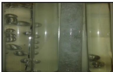
Figura 2-14. Polímeros defectuosos por causa del efecto gel
