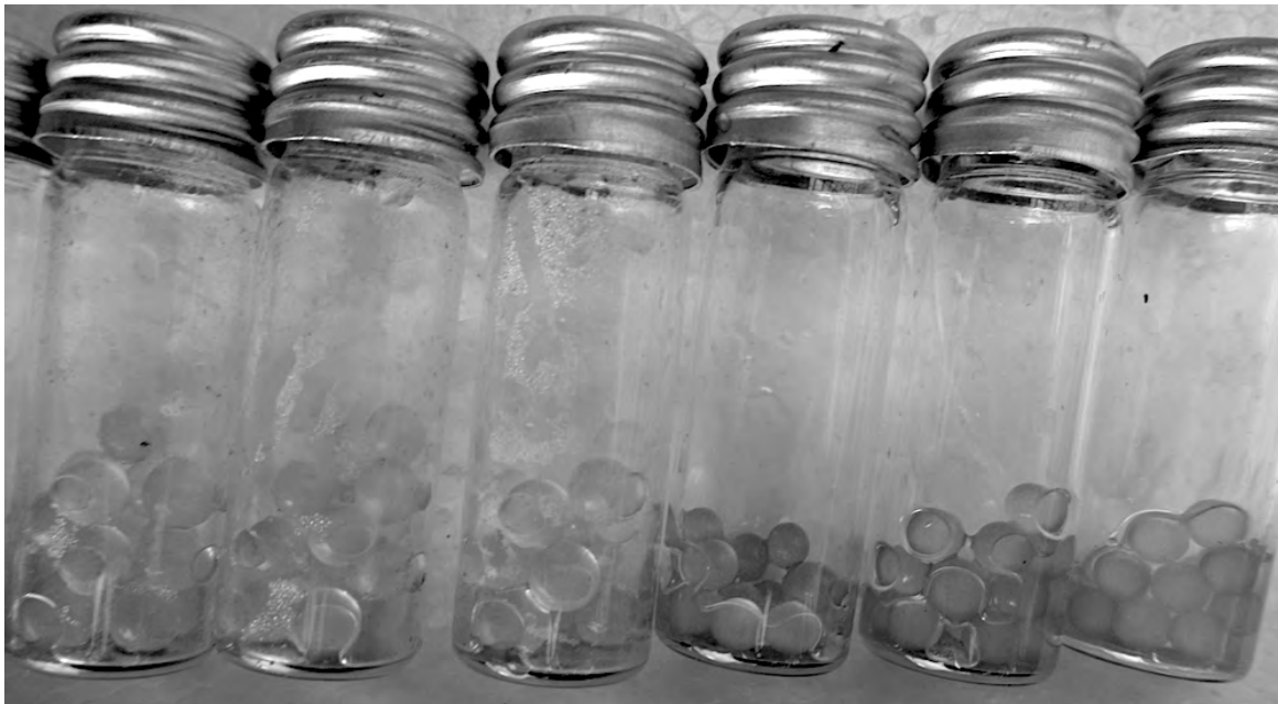
Figura 4. Viales del adaptador HANDY-LPA 2 con las cápsulas de alginato conteniendo Parachlorella kessleri .
