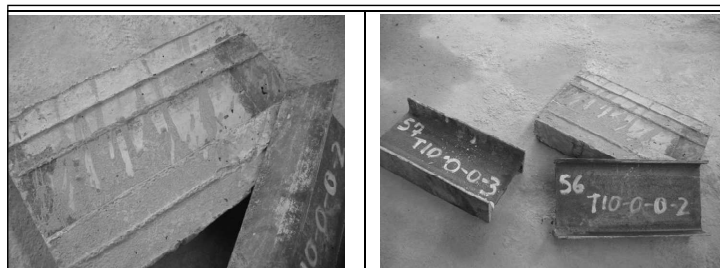
Figura 5. Desencofrado de probetas sin conectores.
