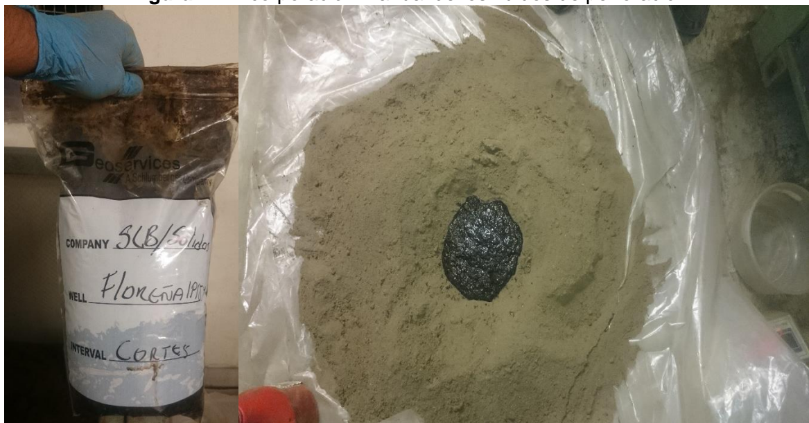
Figura 13. Incorporación manual de los residuos y cortes de perforación
