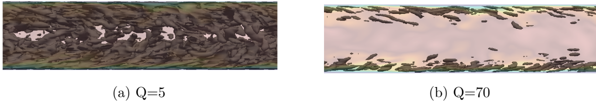
Figura 5.15: Estructuras coherentes tipo Q, formadas en un canal completamente liso
