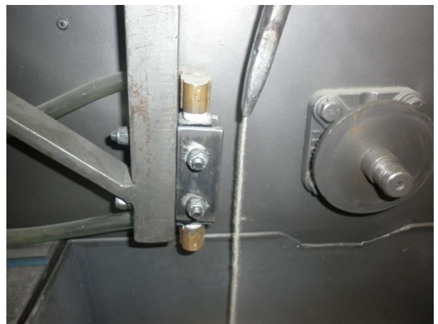
Chumacera ubicada detrás de la rueda
