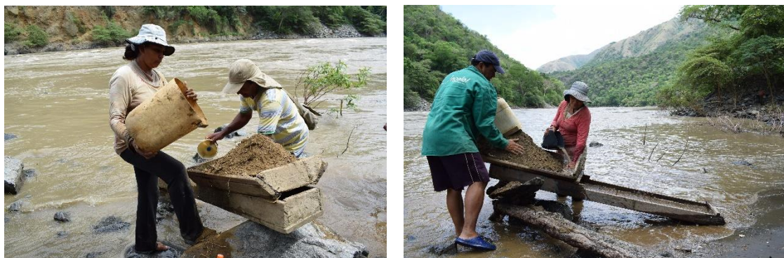
Figura 0-12. Lavado en canalón. Sabanalarga, Antioquia.
