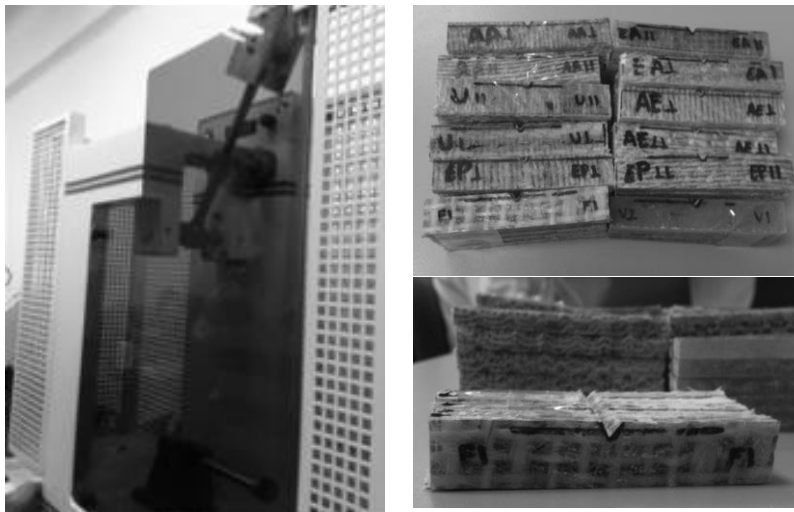
Figura 2-8 a. Máquina prueba de impacto, b. PPB para la realización de la prueba de impacto.
