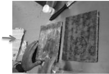
Limpiar y engrasar el molde con el desmoldante.
