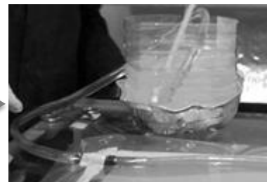
Colocar la resina preparada en el tubo alimentador y abrirlo.
