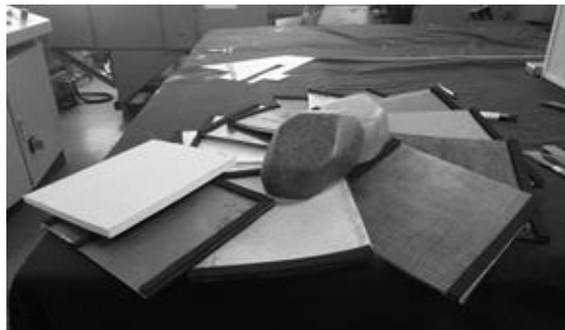
Figura 2-1 Prototipos de materiales bio-compuestos a partir de fibras naturales tejidas.
