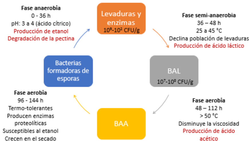
Figura 1-9: Descripción de las etapas de fermentación de las poblaciones microbiológicas y enzimáticas que participan y los principales productos.
