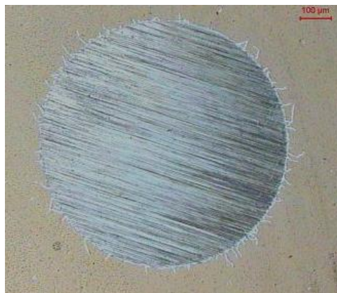
figura 5. 11 Impresión dejada en ensayo CALOTETS: probeta M2S-L, se nota el agrietamiento generado durante el ensayo, lo que no permite una lectura confiable de las dimensiones necesarias, aún así el espesor estimado en esta probeta es de 250nm. El agrietamiento producido en este ensayo es una prueba más de la gran cantidad de esfuerzos residuales a los que esta sometida la capa, lo que genera una pobre adherencia.
