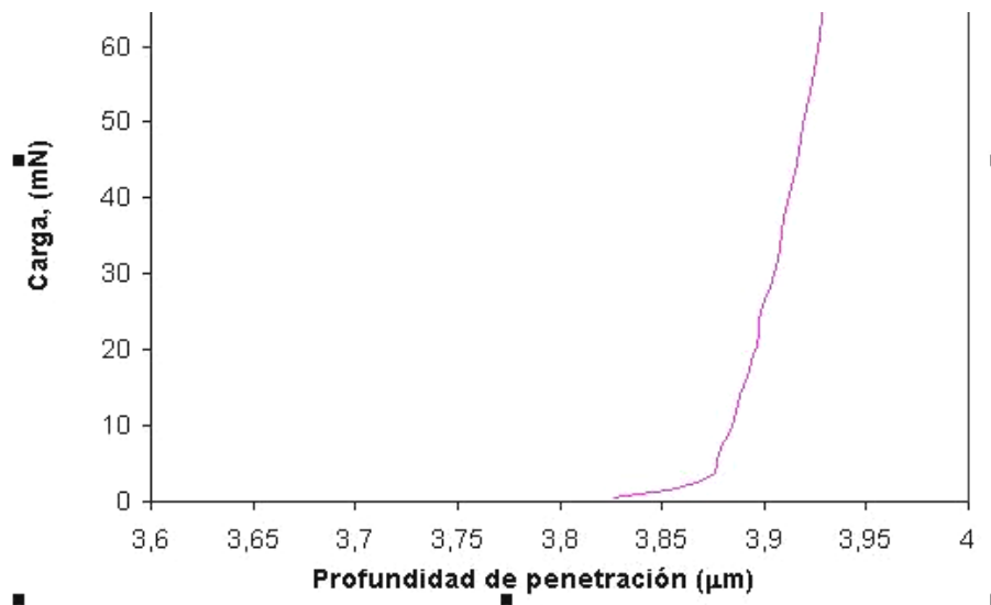
figura 6. 38 porción final de curva D obtenida en acero inoxidable 304L sin recubrir, en la que se muestra una descarga final abrupta.
