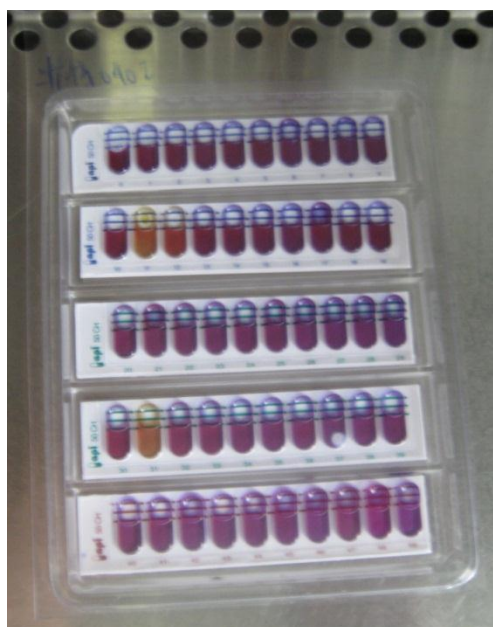
Figura 4-6: Sistema API®50 CHL con 48h de incubación.
