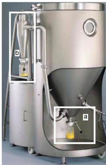
Figura 4-8: Unidad de secado y separación del producto a) Separación primaria b) Separación secundaria, Ciclón (Ángeles, 2009)
