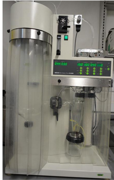
Figura 6-18: Büchi mini Spray Dryer B-290, Suiza
