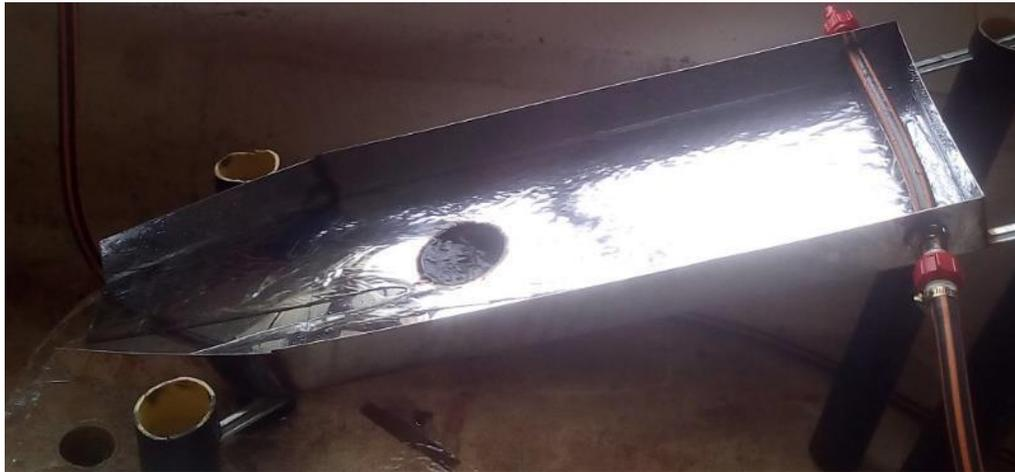
Fotografía 4.7 Aparato para ensayo Inderbitzen, fabricación propia
