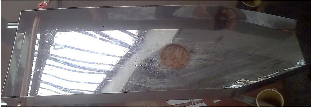
Figura 5.20 Material para ensayo de erodabilidad ensayo Inderbitzen.
