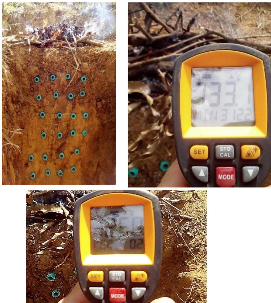
Fotografía 5.1 Temperaturas tomadas en superficie (1250 C°) y a 2,0 cm de profundidad (733 C°).
