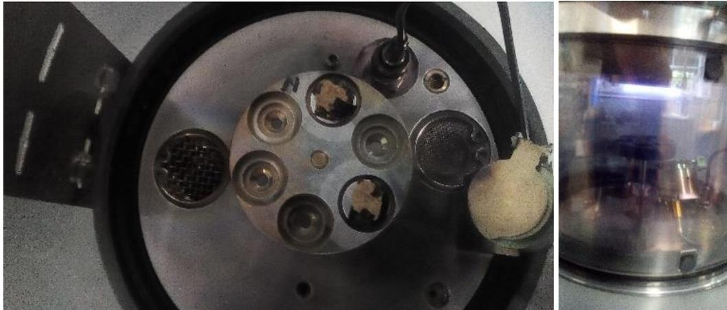
Fotografía 4.6: Preparación de las muestras al recubrirlas con oro para el ensayo de microscopía electrónica de barrido.
