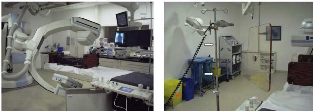
**Figura 5-2.:** Izquierda: Fluoroscopio (Axiom Artis Zeego, Siemens, Erlangen, Germany) utilizado en las pruebas y fantasma antropomórfico. Derecha: Ubicación de los dosímetros para realizar las mediciones de radiación dispersada. Las flechas indican su ubicación. Como protección se utilizó una barrera de espesor equivalente a 0,5 mm de plomo [22].
