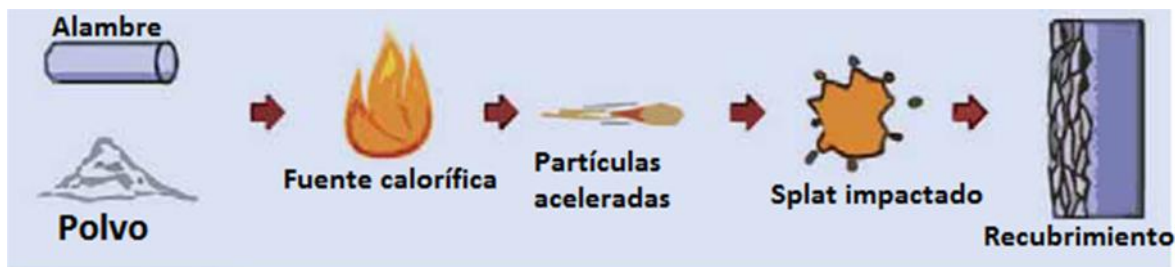
Figura 2.5 Proceso de proyección térmica [31]
