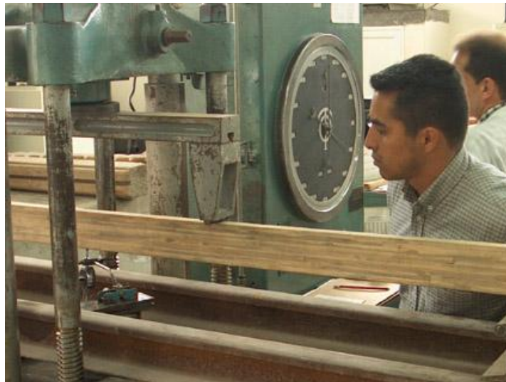
Figura 7 Ensayo a flexión en elementos de guadua laminada U.N. Manizales-GTZ
