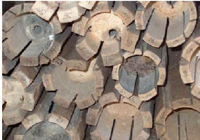
Figura 28 Cortes a la guadua con sierra de discos paralelo Stamm Jörg
