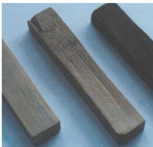
Figura 51 Diferencia de contracción en el secado
