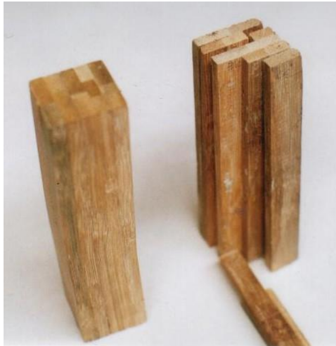
Figura 58 Diferencia en la falla por pandeo entre PC y UF
