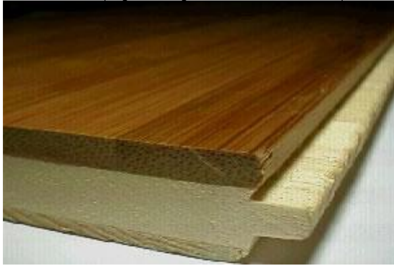
Figura 18 Laminado pegado de guadua con acabado especial Wellmade corp
