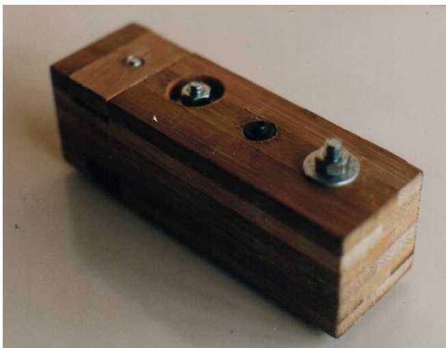
Figura 63 Maquinado con varios diámetros y cajas segunda propuesta
