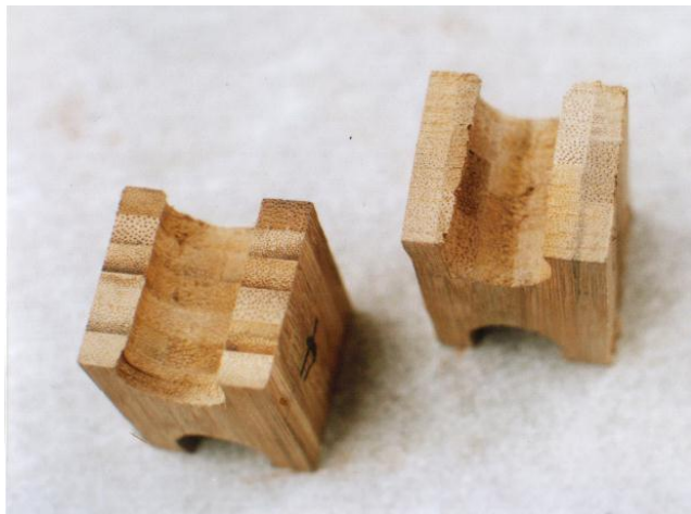
Figura 59 Posición vertical y horizontal para tablillas a tracción perpendicular
