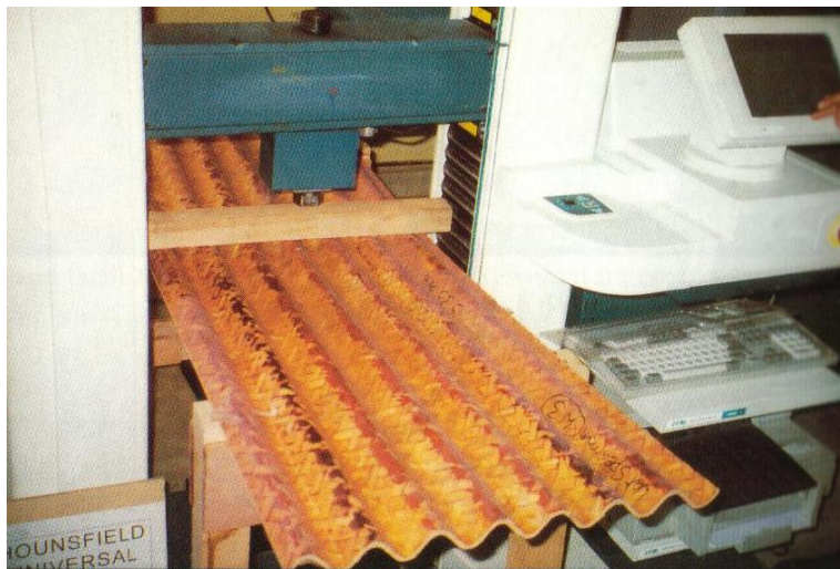
Figura 15 Teja ondulada de aglomerado de partículas de bambú IPIRTI
