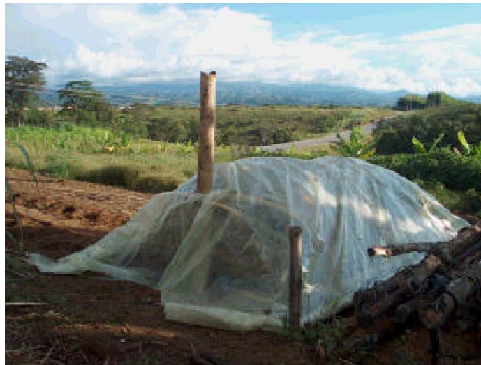
Figura 30 Secador solar para tablillas de guadua Stamm Jörg
