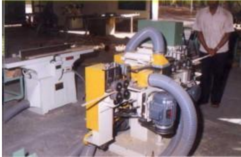
Figura 14 Planeadora para bambú IPIRTI
