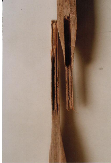
Figura 61 Falla del material por tracción paralela
