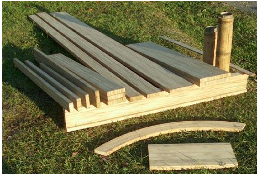
Figura 35 Vigas ensayadas a flexión Stamm Jörg
