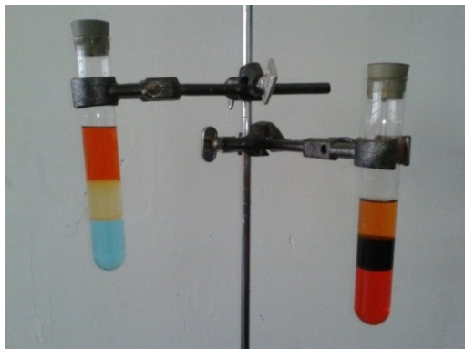
Figura 5-1: Actividad experimental sobre la formación de fases usando agua, aceite, etanol y colorantes
