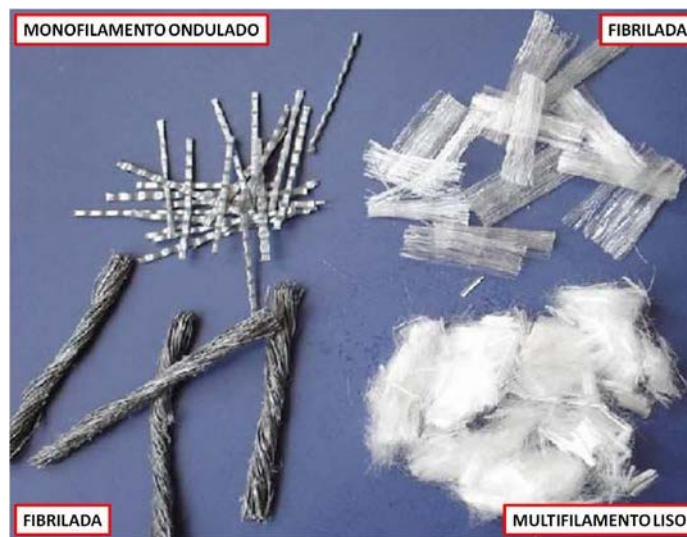
Figura 18. Tipos de fibras de polipropileno, comercialmente disponibles [ACI Committee 544 2002; Pujadas 2008; Mármol 2010].
