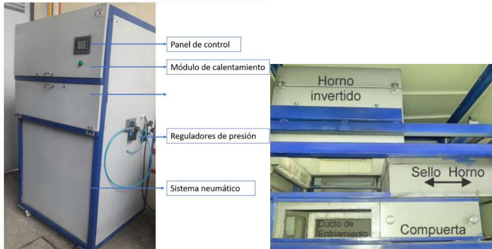
Figura 3-5. Horno de ensayos cíclicos. Adaptado de [95]
