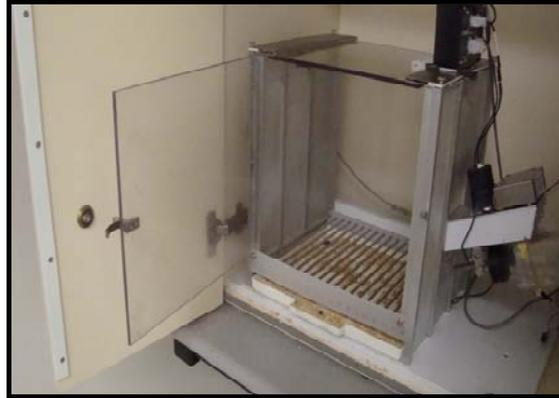
**Figura 14.** Caja de condicionamiento adaptada para el entrenamiento de tareas consumatorias usando un mecanismo automático de introducción del bebedero.
