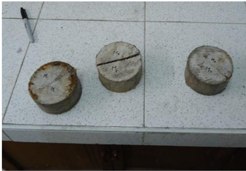
Figura 6.15. Montaje NT Build 492. Muestras falladas al finalizar el ensayo.
