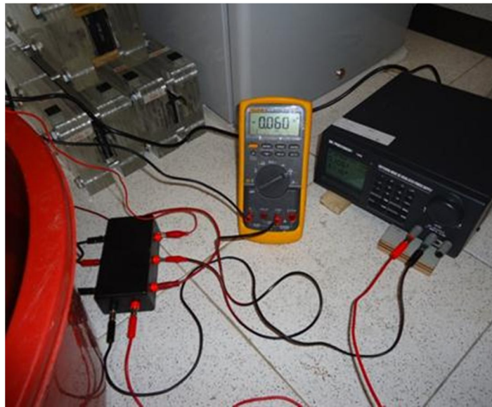
Figura 6.14. Montaje NT Build 492. Lectura de la corriente inicial, I_0 .
