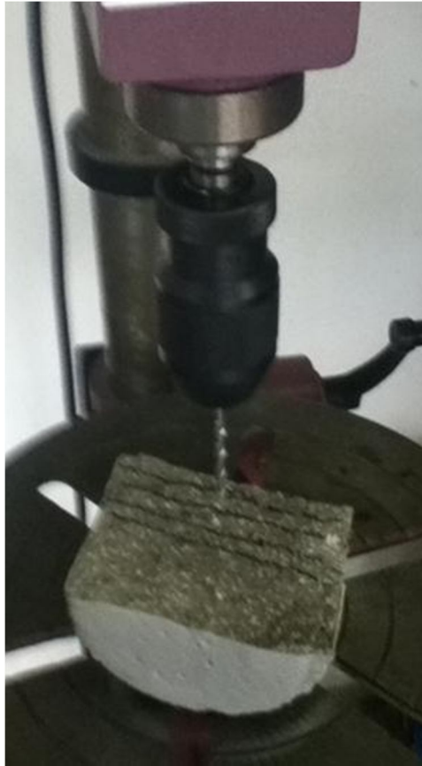
Figura 6.19. Toma de muestras mediante un taladro de árbol.
