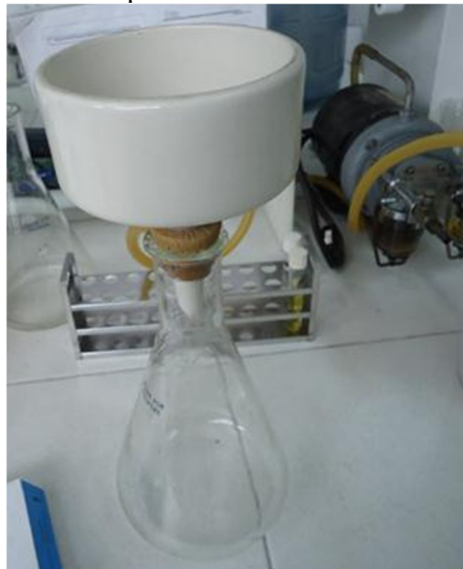
Figura 6.6. Ensayo C1152. Embudo, matraz y bomba de vacío para el filtrado de la muestra
