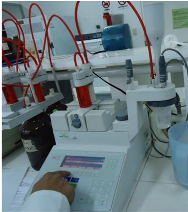
Figura 6.8. Ensayo C1152. Medición de cloruros totales mediante el titulador electrónico.
