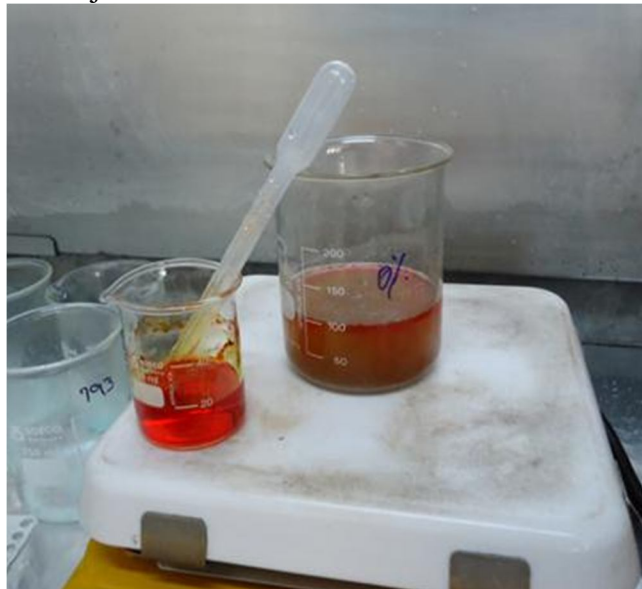
Figura 6.4. Ensayo C1152. Agregar 3 gotas de naranja de metilo.
