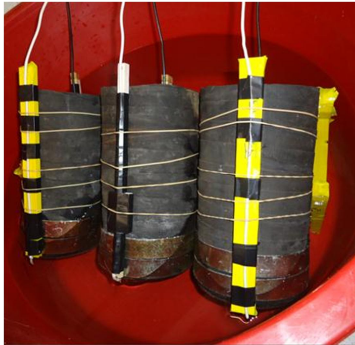
Figura 6.10. Montaje NT Build 492. Disposición de las muestras. Vista posterior
