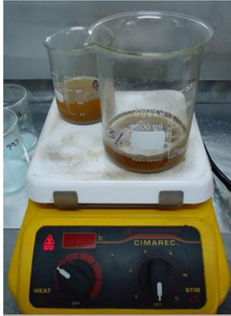
Figura 6.5. Ensayo C1152. Calentar la muestra y dejarla hervir por 10 segundos.
