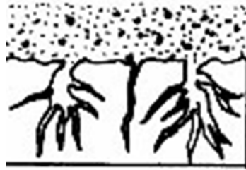
Figura 2.8 Corrosión bajo esfuerzo
