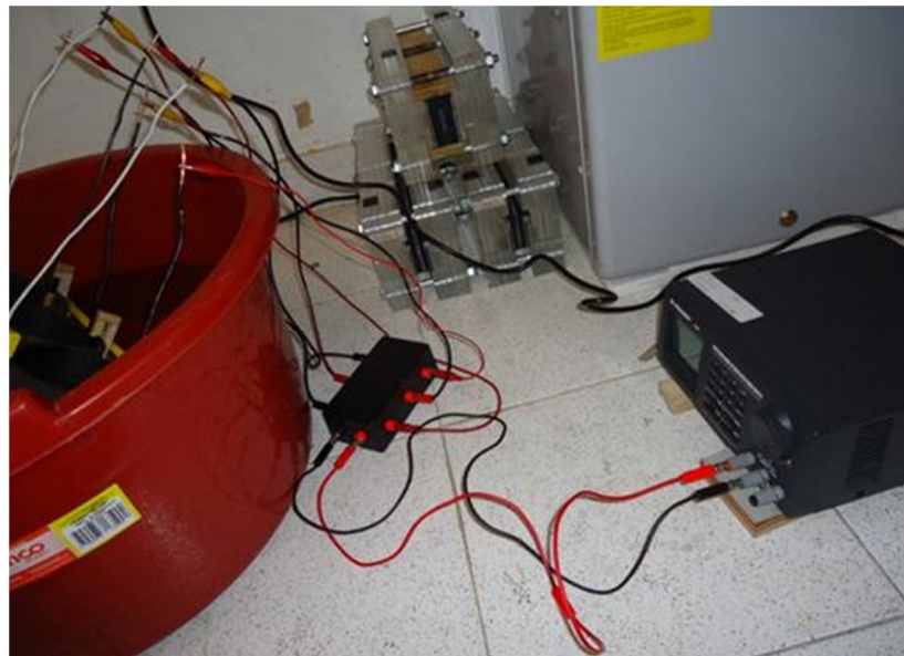
Figura 6.12. Montaje NT Build 492. Muestras conectadas en paralelo.
