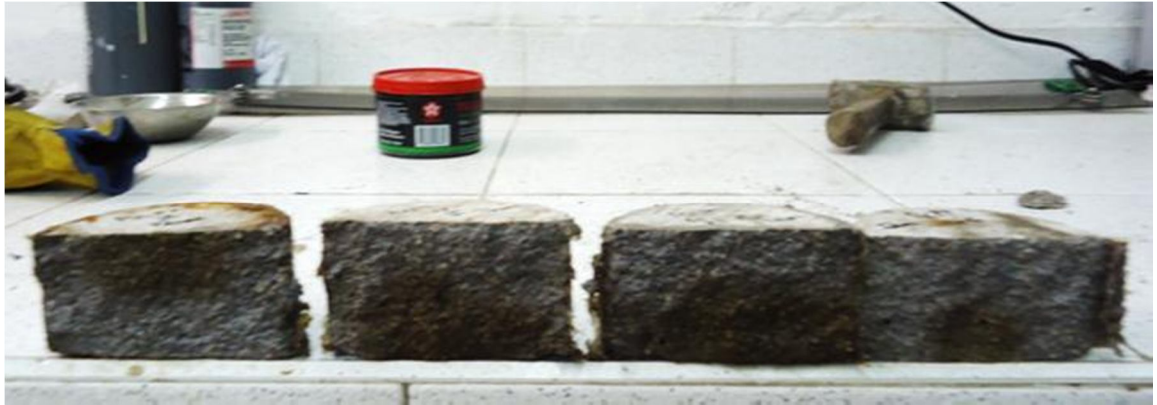
Figura 6.22. Probetas de RCPT falladas para hacer la medición de puntos del perfil de penetración.
