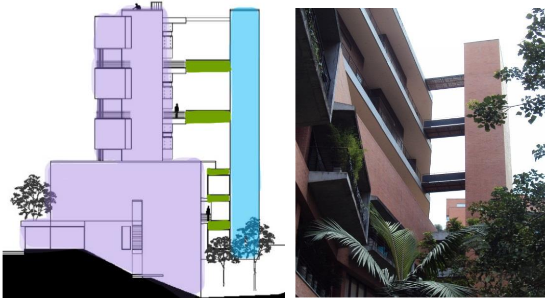
Figura 102. Conexión entre volúmenes (morado y azul), en estructura metálica (en verde).
