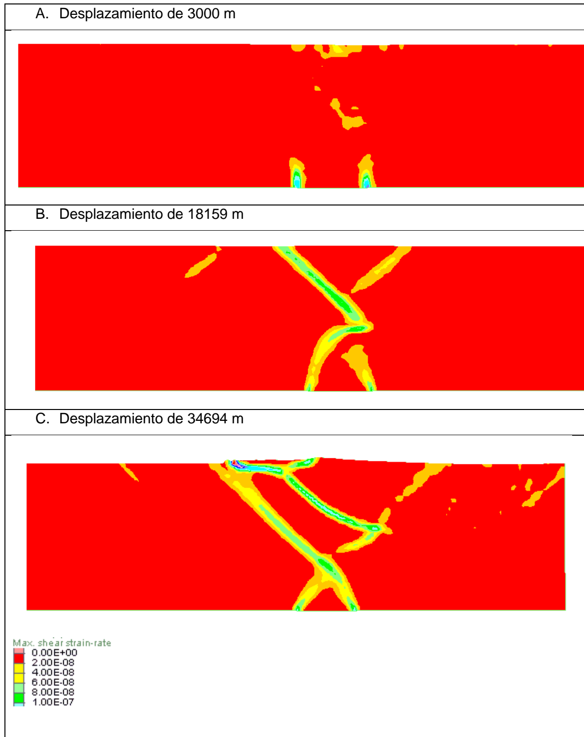
Figura 4.18 Máxima tasa de deformación cortante para el modelo Subducción Placa Oceánica - Continental. A) Desplazamiento de 3000 m. B) Desplazamiento de 18159 m. C) Desplazamiento de 34694 m.
