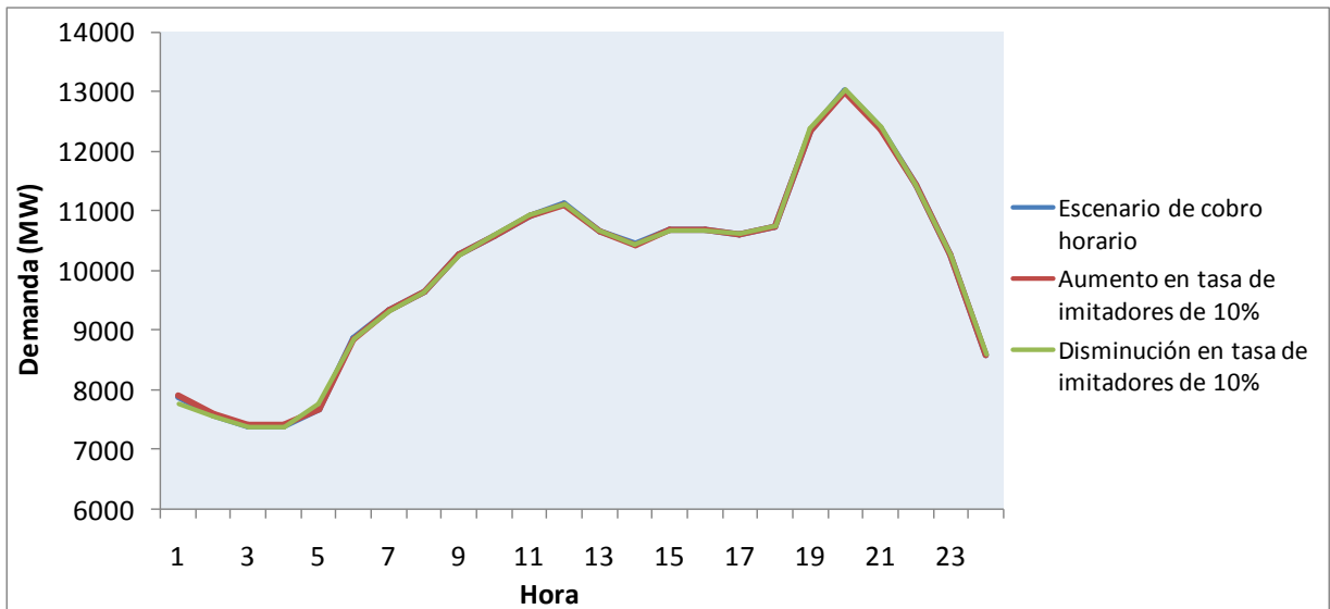
Figura 10-8. Curva de carga Escenario de cobro horario Vs. cambios en la tasa de imitadores
