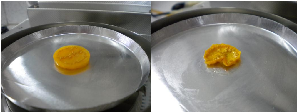
Figura 3.11. Izquierda: muestra para realizar la medida de contenido de humedad inicial; derecha: muestra al finalizar la medida.
