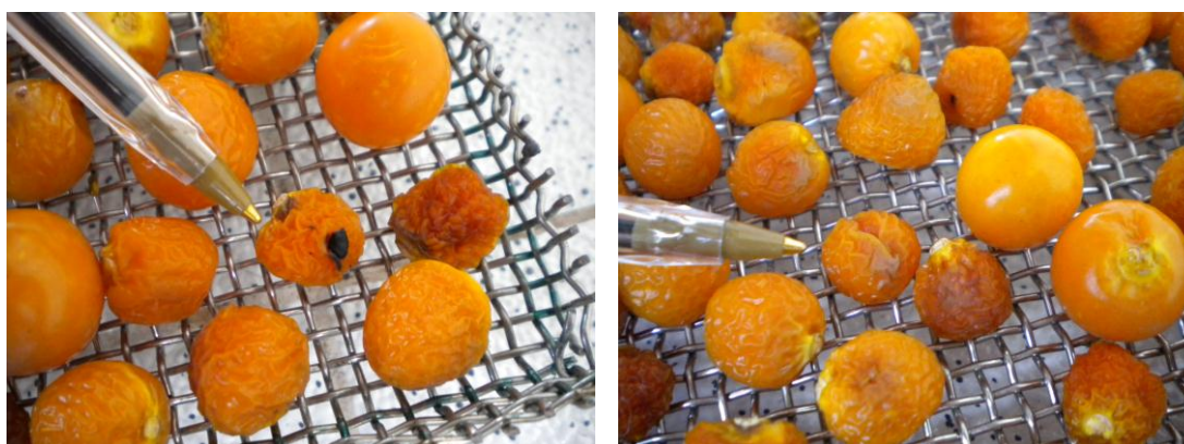
Figura 4-1. Ataque de hongos y de micro-organismos en ensayo a 40°C y 20 %HR.
