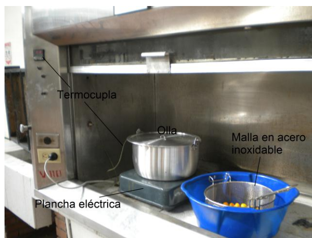
Figura 3.12. Montaje para la realización del escaldado de la uchuva.
