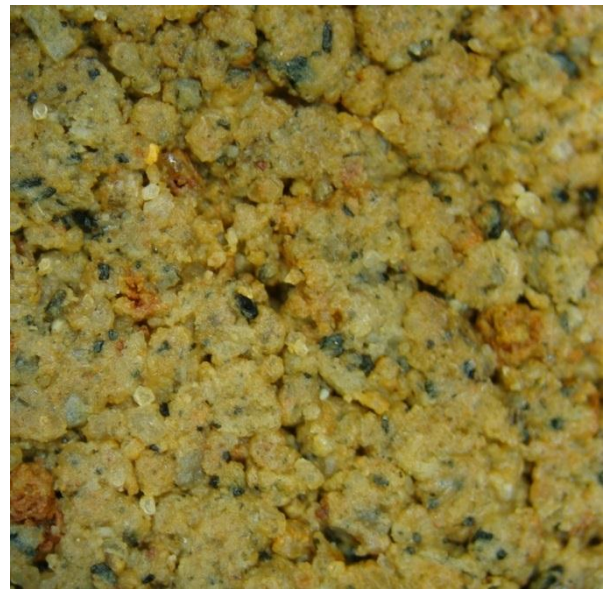
Fotografía 5.2. Suelo compactado estáticamente. ( \rho_d=0.95 \text{ gr/cm}^3 y w=56\% .)
