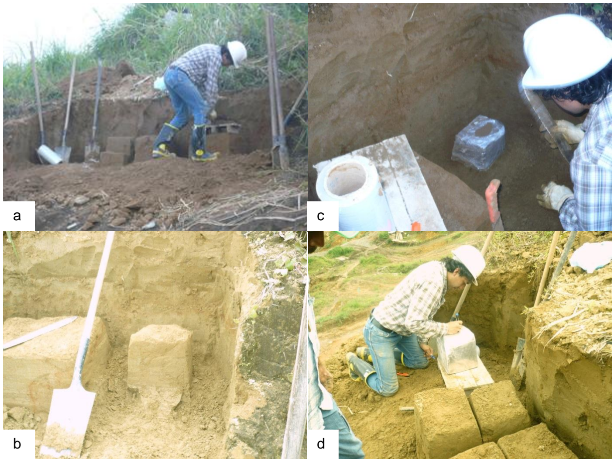
Fotografía 3.1. Actividad de muestreo del material derivado de ceniza volcánica. a) aspecto de la trinchera de profundidad entre 0.6m y 0.9m, b) tallado de bloque in situ, c) Empaque lateral del bloque, d) Embalaje y rotulado final. Aeropuerto del Café. 2010.
