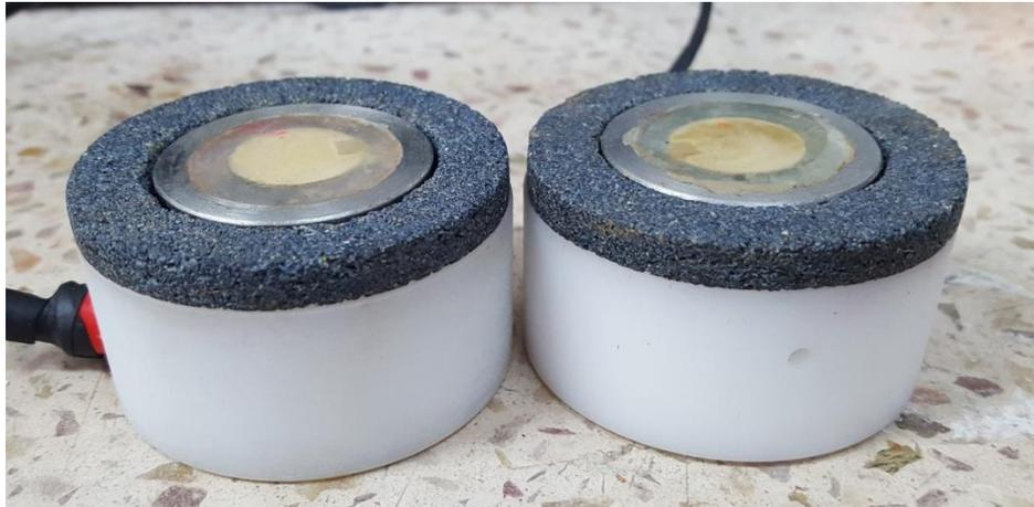
Fotografía 4-5. Detalle de los transductores fabricados para la investigación.
