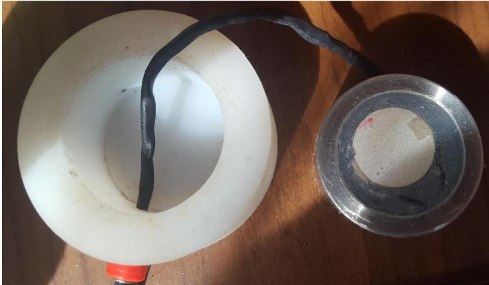
Fotografía 4-4. Transductor de velocidad de onda (derecha) antes del montaje en la pieza de teflón (Izquierda).
