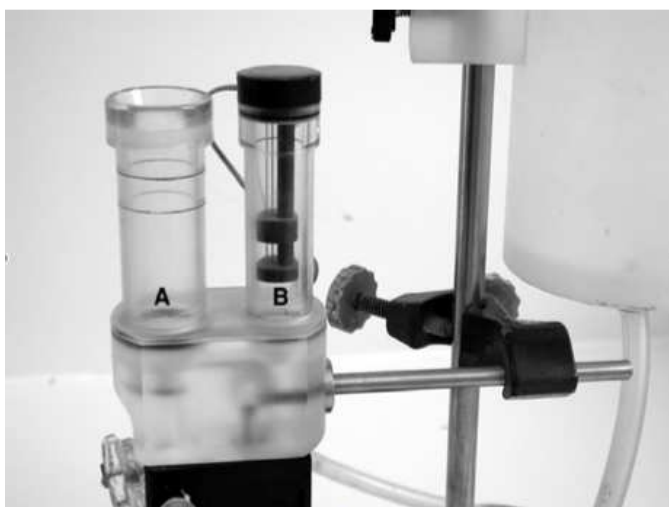
FIGURA 3-2: Pletismómetro Ugo Basile® de desplazamiento de agua.
