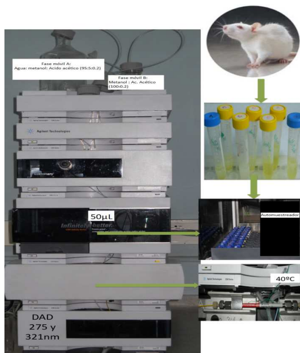
Figura 3-1: Esquema gráfico de las condiciones experimentales para el desarrollo de la metodología analítica.
