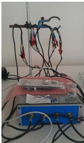
Figura 2-13 Imagen del sistema empleado para realización de mediciones electroquímicas
