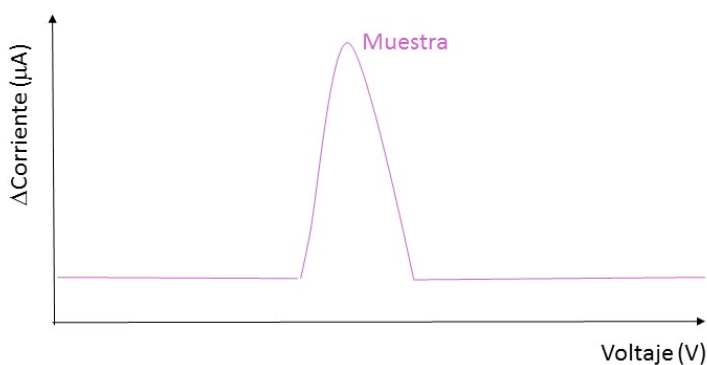
Figura 2-10 Diferencia de corriente para voltametría de onda cuadrada
